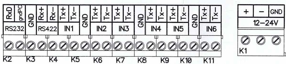
Рис. 1. Распределение контактов мультиплексора Beta 100 на выходной плате коммутации.
